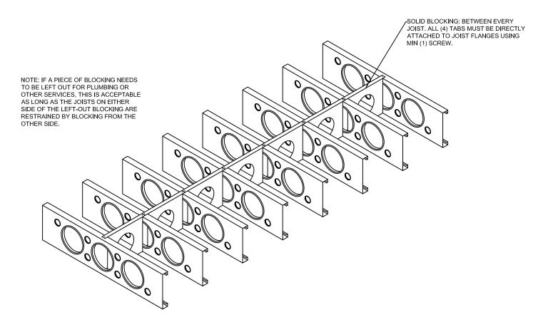
BLOCKING MUST BE PERPENDICULAR TO JOISTS. BLOCKING MAY BE OFFSET UP TO 2" EITHER SIDE OF BLOCKING LINE.
